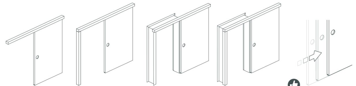
Die Grundversion: Das Schiebetürelement wird direkt auf der Wand montiert. Eine hochwertige Laufschiene sorgt für leises und gleichmäßiges Gleiten der Tür. Der dezente, dekorgleiche Abdeckwinkel deckt die Laufschiene zuverlässig ab. Einfacher gehts nicht.
