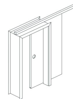
Schiebetür in der Wand laufend für maßgerechten, individuellen Einbau in bauseits vorhandene Wandöffnungen. Der Übergang von Wandöffnung zur Zarge muss entsprechend vorbereitet werden.
