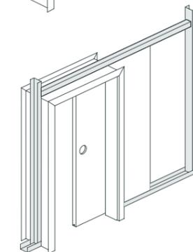
Schiebetür in der Wand laufend für Fertigkastensysteme. Die vorgefertigten Konstruktionen namhafter Hersteller werden in Trockenwände oder Mauern eingebaut. Die speziell darauf abgestimmte Zarge deckt die Wandöffnungsrisse zuverlässig ab.
