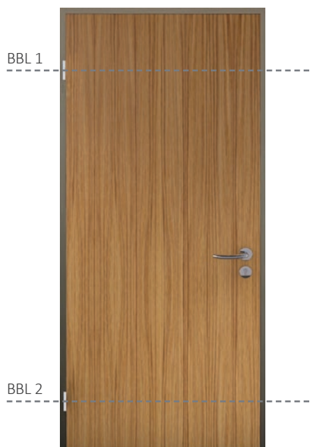
Bandbezugslinien · Bandaufnahmen V8618 und BTV10200 · Darstellung: zwei Bandaufnahmen
